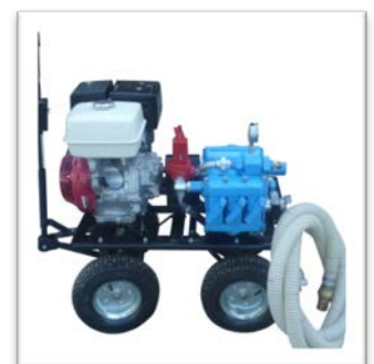
Pompe d'injection thermique
