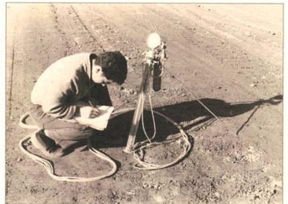
*Pressiomètre type C pressuremeter - 1957*
