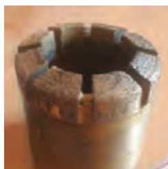
USURE EXTÉRIEURE DE LA COURONNE
