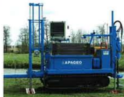
Le pénétromètre statique Geomil permet de réaliser des essais de pénétration avec un poussage par vérin.
