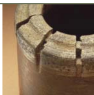
Usure extérieure de la couronne :
