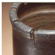
Fissures dans les segments
