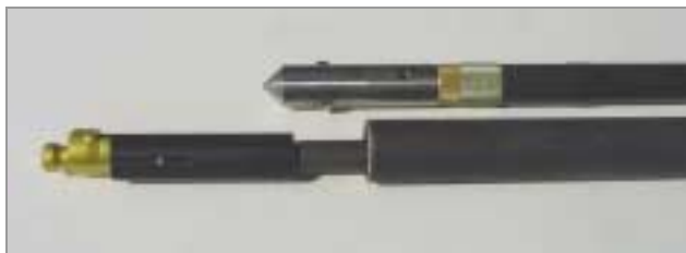
Outil STAF®, porte outil, tige, tube fendu Positionneur de sonde et sonde 44 Ménard
