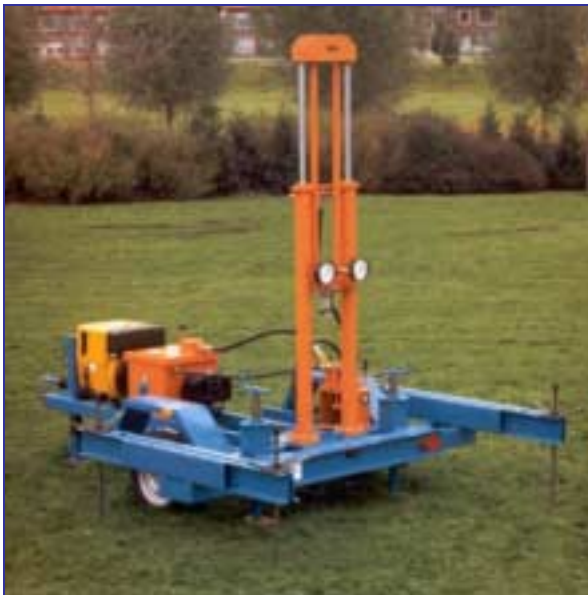
Pénétrromètre 200 kN sur remorque
