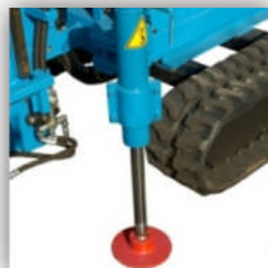
Pied hydraulique de stabilisation Hydraulic jack for stabilisation
